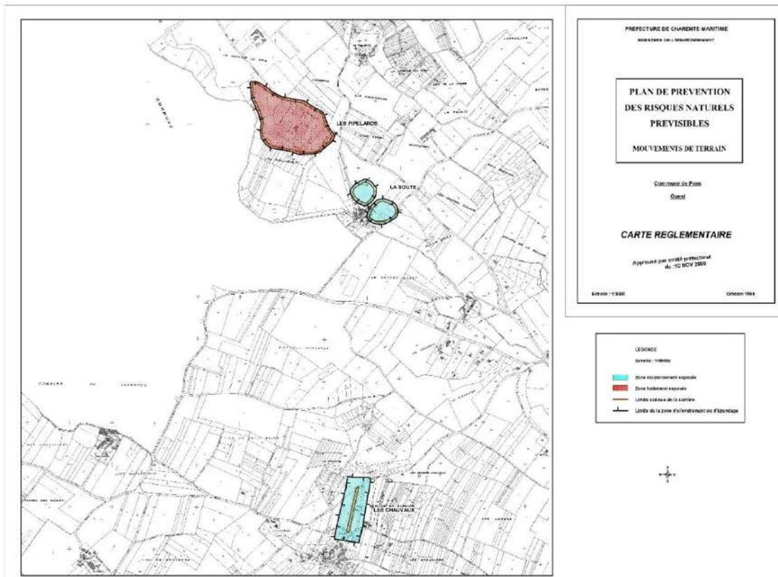
Figure 52 : Zonage du PPR mouvement de terrain à Pons – secteur ouest
